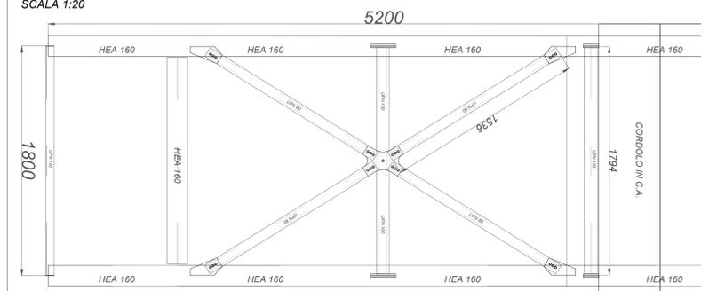
SEZIONE STUTTURA IMPALCATO
